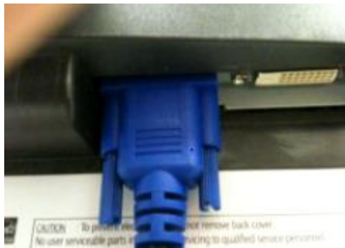
Câble vidéo branché sous l'écran
